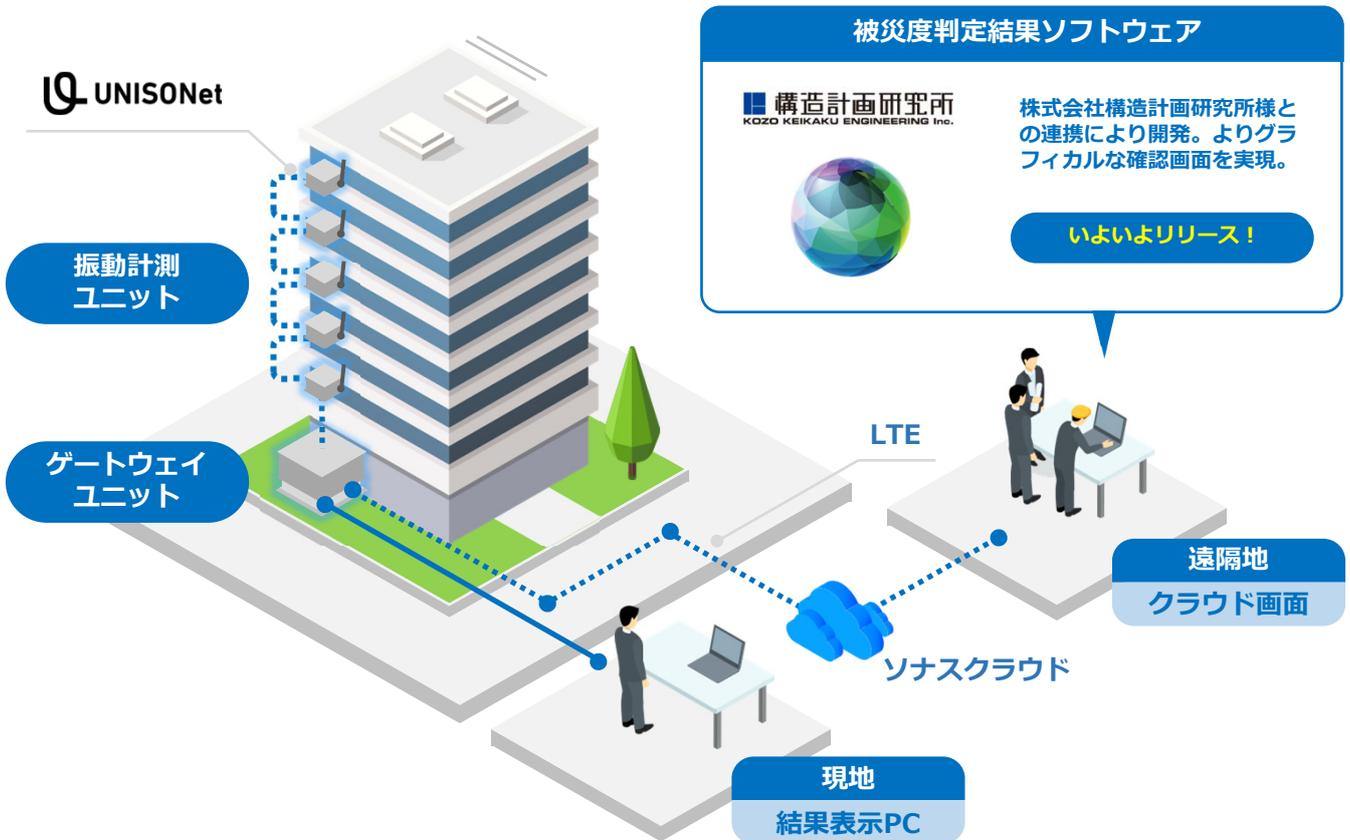
建物の振動データを無線で収集し、クラウドで解析して結果を出力します。
